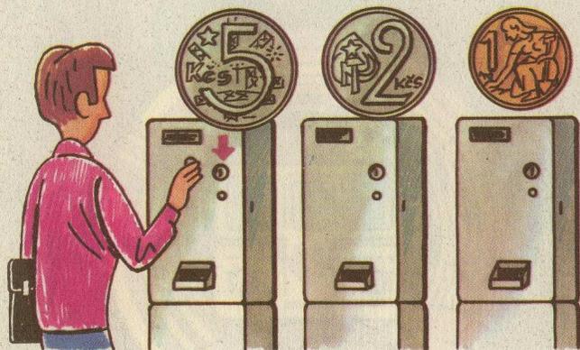
Měníče mincí slouží ke směně mince hodnoty 5 Kčs, 2 Kčs a 1 Kčs nové emise za odpovídající počet mincí hodnoty 1 Kčs staré emise. Na každou hodnotu mince je samostatný měnič.
